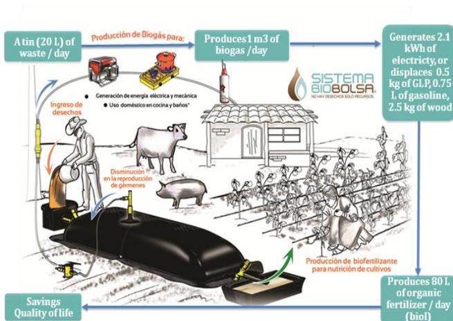
Fonctionnement d'un biodigesteur (Biobolsa)
